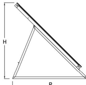
Ingombri massimi in mm: **tetto piano** LxPxH = 1200x2000x1650    Peso a vuoto 80 kg
